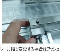
ドさせ変更するレール幅で指を離 せばロックされレール幅が固定され ます。
