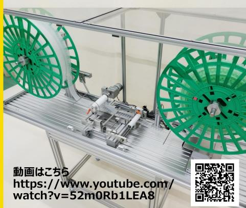
■カバーテープの剥離と ピッチフィードができます ■ユニットの取付、部品の追加 が自由にできます
